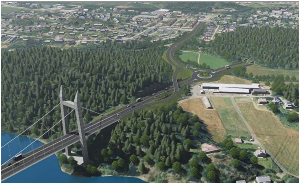
Figur 2: Kryssløsning ved Smørberg og tverrforbindelse via Bekkeveien til fv. 303 ved Vear.
